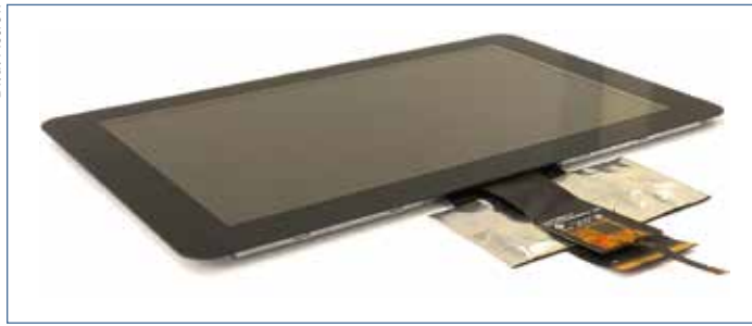
Bild 1: Dank einheitlicher Pinbelegung lassen sich die Displays mit dem ACT I 3 untereinander tauschen.
